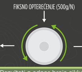
Koristeći kružnu oštricu koja se pomera napred-nazad pod konstantnim opterećenjem od 500g, ovaj test meri broj ciklusa potrebnih da se proseče materijal rukavice koja se testira.
