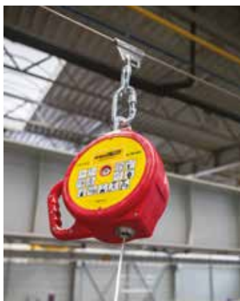
Skica 8: Primena horizontalne linije života u slučaju potrebe za velikom mobilnošću pri radu na visini.
