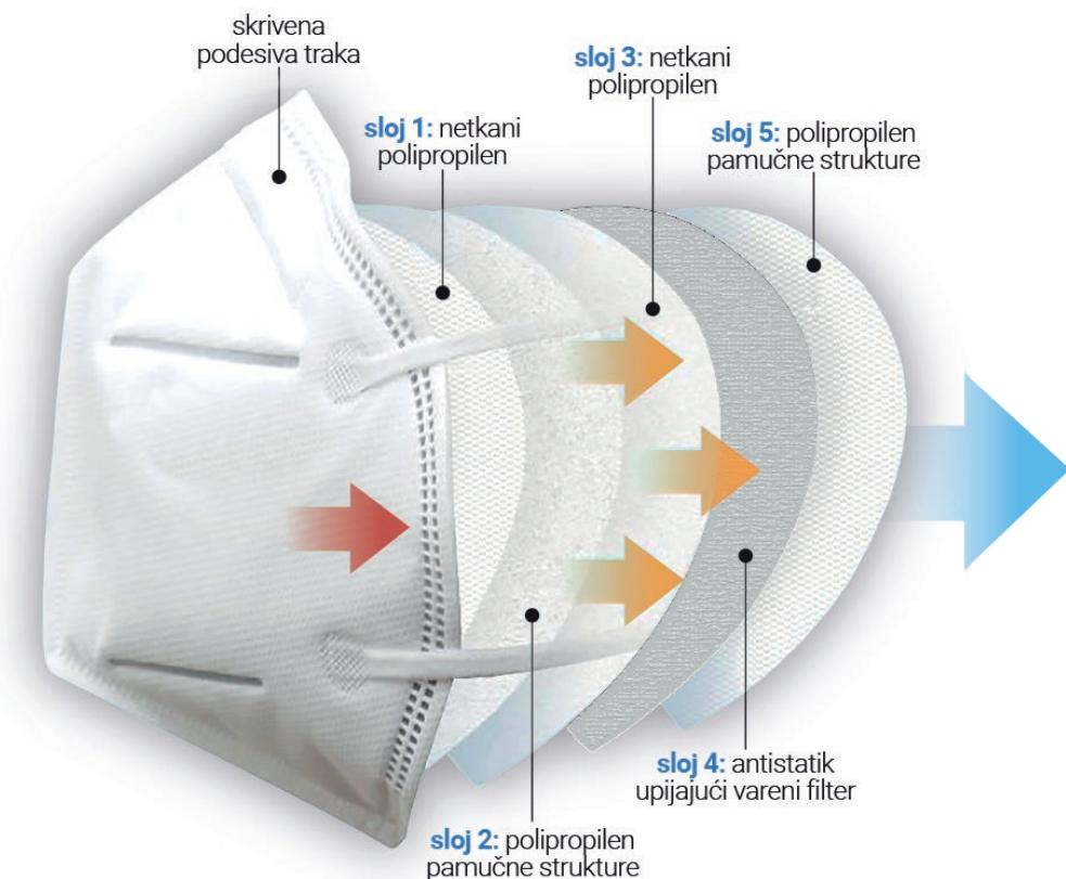
Respiratori se mogu sastojati od 3 do 5 slojeva filtracionog materijala. Na poprečnom preseku prikazanom na slici možemo videti od čega se sastoji jedan industrijski respirator.
